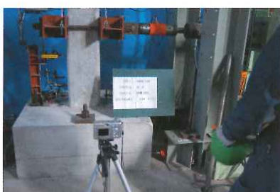
5 せん断破壊試験状況 正側 1/50 第1回目
